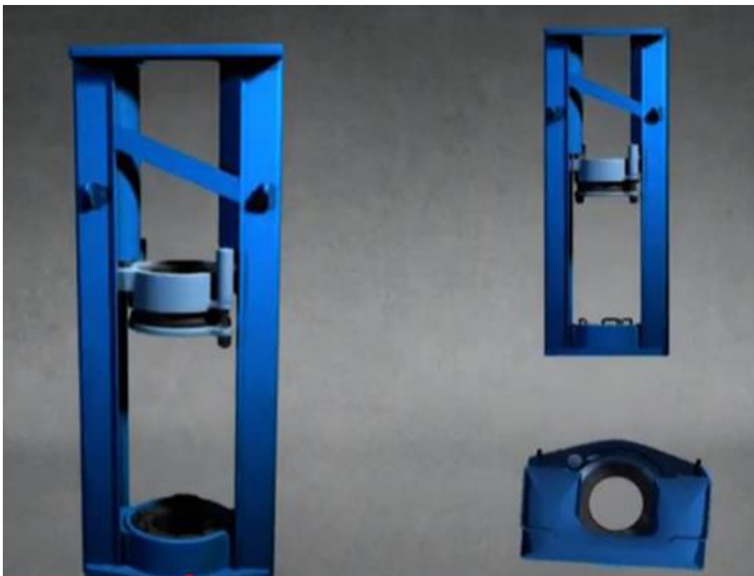
Figura 23 – La pressa oleodinamica atta ad infiggere man mano gli spezzoni di palo nel terreno.
